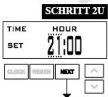
**SCHRITT 2U:** Aktuelle Uhrzeit (Stunde): Stellen Sie die Stunde der Uhrzeit mit der Taste ▼ oder ▲ ein. Wählen Sie „**NEXT**“ (Weiter), um zu Schritt 3U zu gelangen.
