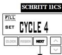
**Schritt 11CS:** Drücken Sie ▲ oder ▼, bis „FILL“ (Befüllen) angezeigt wird. Wählen Sie „NEXT“ (Weiter), um zu **Schritt 12CS** zu gelangen. Wählen Sie „REGEN“ (Regeneration), um zum vorherigen Schritt zurückzukehren.
