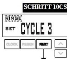
**Schritt 10CS:** Drücken Sie ▲ oder ▼, bis „RINSE“ (Spülung) angezeigt wird. Wählen Sie „NEXT“ (Weiter), um zu **Schritt 11CS** zu gelangen. Wählen Sie „REGEN“ (Regeneration), um zum vorherigen Schritt zurückzukehren.
